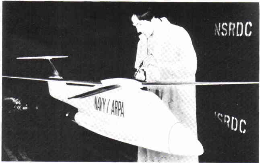
Modell till kombinationen fpl-hkp i 1/4 skala vid Lockheed i Calif för test. Vid start och landning som en helikopter och som konventionellt flygplan i planflykt – en önskedröm.
